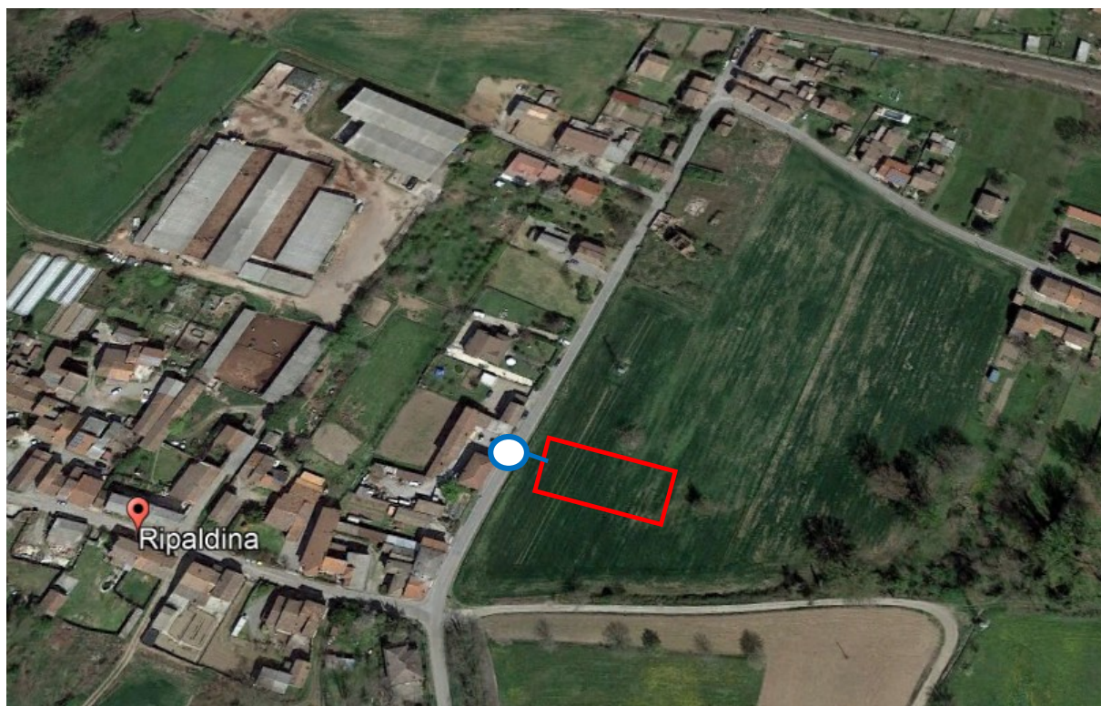
Fig.26: Misure strutturali da prevedere in Fraz.Ripaldina Nuovo pozzetto con tubazione di troppo pieno (blu) e invaso di laminazione (rosso)
